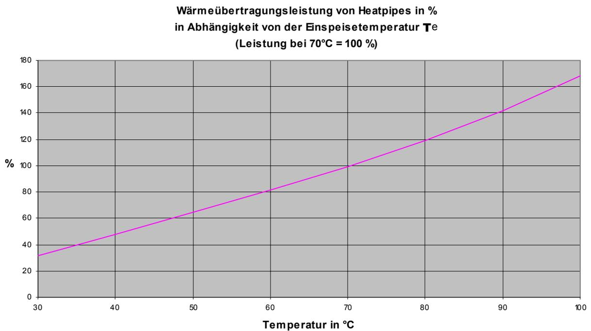
**B**ei vertikaler Einbaulage und der Wärmeeinspeisung am unteren Ende haben Heatpipes den besten Wirkungsgrad. Mit Zunahme der Neigung in Richtung Horizontale verringert sich die Wärmetransportleistung geringfügig. Für den Fall, dass die Wärmeeinspeisung oben liegen soll, sind spezielle Heatpipes zu verwenden, deren Innenoberfläche durch Spezialbehandlung einen verstärkten Kapillareffekt bewirken.
