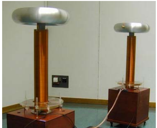
Abb. 16: Nachbau von zwei Tesla-Spulen
