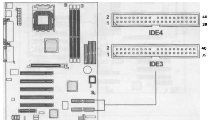
**TIPP** *Wenn Sie zwei Festplatten an einem Kabel installieren, müssen Sie das zweite Laufwerk durch Setzen des Jumpers für den Slave-Modus konfigurieren. Wenn Sie wissen wollen, wie der Jumper gesetzt wird, schlagen Sie in der mitgelieferten Dokumentation Ihrer Festplatte nach.*
